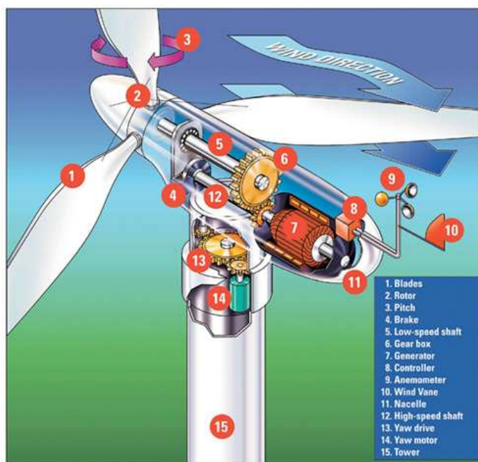
ภาพที่ 6.6 แสดงตัวอย่างส่วนประกอบของกังหันลมเพื่อการผลิตไฟฟ้า ที่มา (Power House. 2005. On-line)
