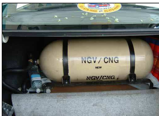
ภาพที่ 3.2 แสดงตัวอย่างการใช้ก๊าซมีเทนเป็นเชื้อเพลิงในรถยนต์ที่มา (กรมธุรกิจพลังงาน. 2547. ออน-ไลน์)
